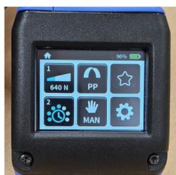
**Interface utilisateur entièrement tactile :** réglage aisé des paramètres et des informations d'état de l'outil
