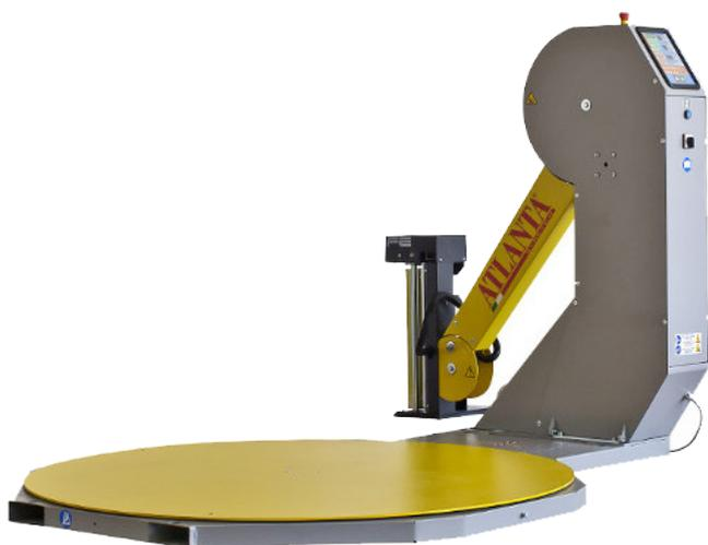
Grâce au bras articulé, la hauteur de plafond n'est pas un problème. Il suffit de régler la fin de course supérieure du bras pour limiter la hauteur maximum du chariot et éviter ainsi de dépasser le plafond.
