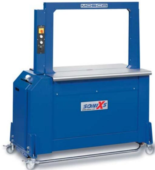
**SONIXS MP** : cerceuse très haute cadence à soudure ultrason (technologie brevetée par Mosca) permettant de cercler 70 produits/minute en feillard de 5 à 12 mm – Intégration possible de presse simple et double automatique. Arche de 500 x 400 mm à 1000 x 800 mm.
