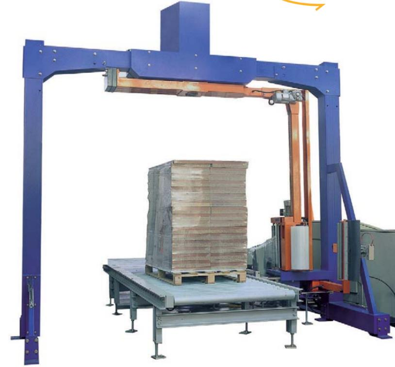
Banderoleuses automatiques à bras tournant pour fin de ligne de production/conditionnement/emballage – Jusqu'à 100 palettes/heure en fonction des modèles – Possibilité de pose de coiffe automatique – Pré-étirage motorisé jusqu'à 300%.
