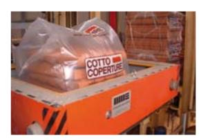
Cadre de rétraction équipé de 4 brûleurs à flamme indirecte, indépendants. Un dispositif d'aspiration permet l'accrochage de la housse au pied de la palette lors de la rétraction. Cadence: 180 pal/h
