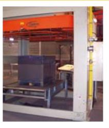
Le cadre de rétraction FT30, équipé d'une hotte de récupération de la chaleur, rétracte des palettes de dimensions très variables. Il peut être intégré dans une ligne de convoyage ou les palettes peuvent être transportées sous le cadre par l'intermédiaire d'un chariot de transfert.
