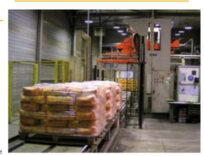
Housseuse de gaine étiro-rétractable à froid garantissant une stabilité optimale du produit emballé **sans l'emploi de chaleur**, grâce à l'élasticité et à la force de serrage du film.
