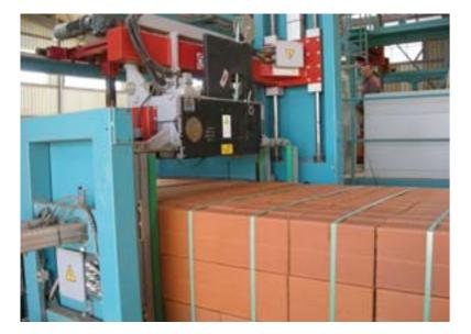
**Cercleuse verticale :** Cercleuse conçue pour le cerclage vertical de charges palettisées lourdes (avec ou sans aiguille). Possibilité de positionner la cercleuse sur un chariot de transfert pour réaliser plusieurs cerclages sans bouger la charge palettisée.
