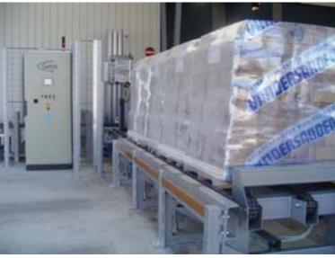
AV620/AV750: Banderoleuse à bras tournant pour des hautes cadences. Pré-étirage électronique motorisé jusqu'à 300 %. Possibilité de dépose de coiffe en automatique.
